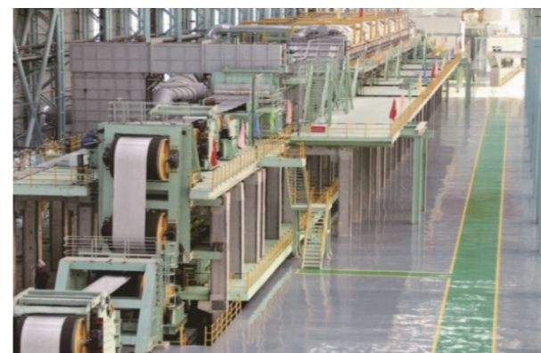
60万吨热轧不锈钢退火酸洗自动化生产线
