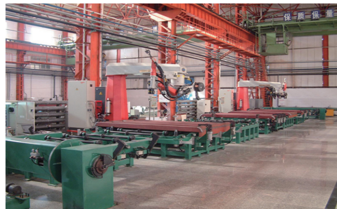
敞车端墙焊接机器人生产线
