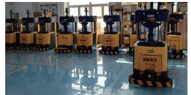
经济型物流移动搬运机器人（AGV）系列产品 （国家“十二五”先进制造领域863计划支持项目）
