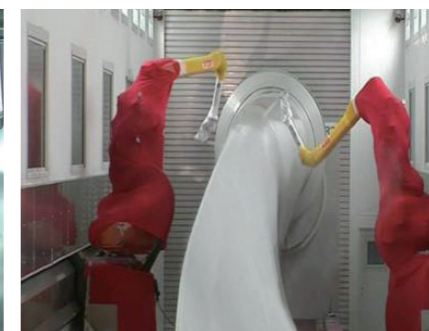
风力发电叶片表面自动喷涂工作站
