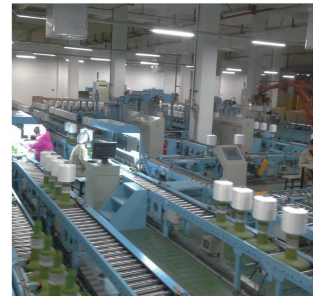
化纤生产机器人智能物流成套设备（国家首批“智能制造装备发展专项”资金支持，成功应用于江苏盛虹集团）
