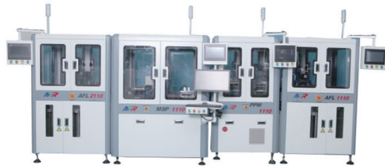
全自动组合（自动上料机+多工位加工机+PSA 贴敷机+AVI 缺陷检测机+自动下料机）
