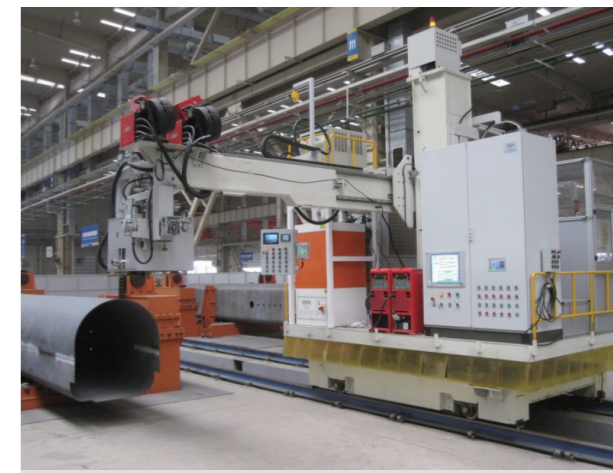
国内自行开发的第一套大功率固体激光-熔极电弧复合焊接装备
