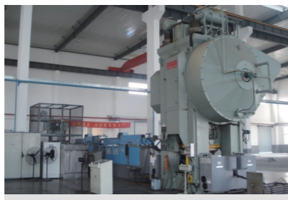
MP系列热模锻机械压力机及全自动锻造中心
